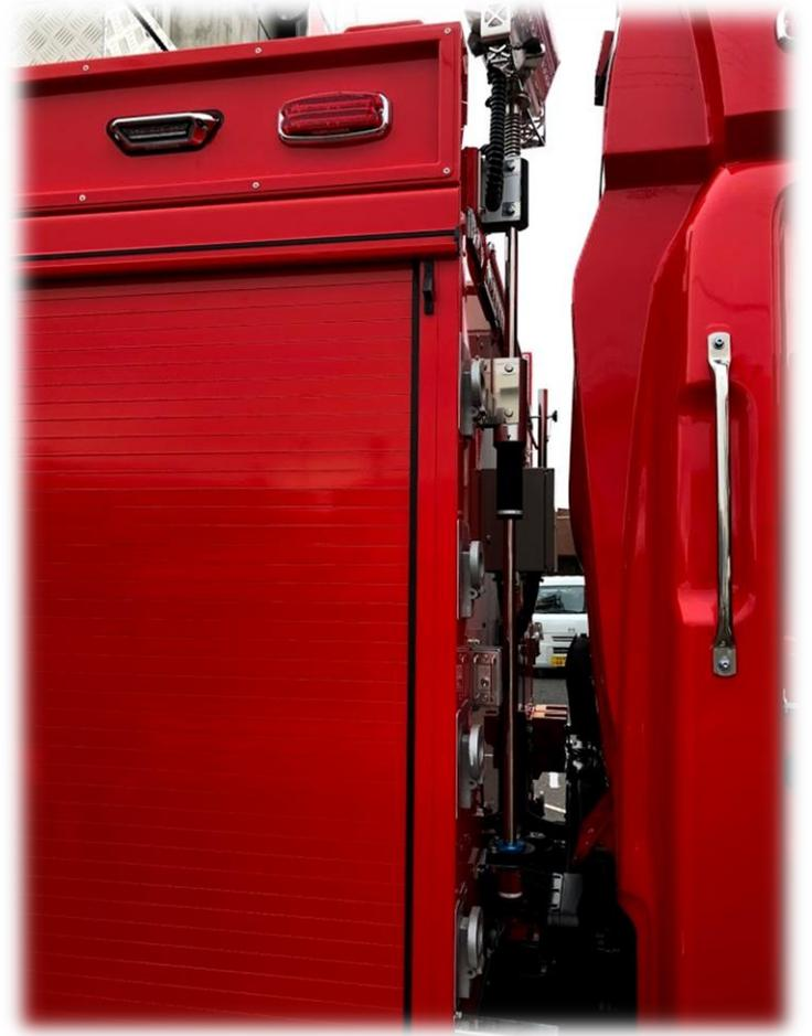
キャブとボディーの間にすっきり収納。ロックを解除すれば上に伸ばせます。
