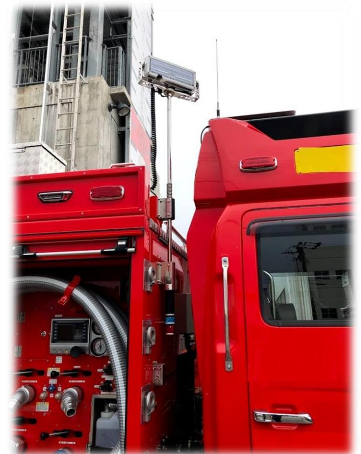
ポール根元の握りを回すだけで、旋回はもちろん、縦方向のチルト（俯仰）もできます
